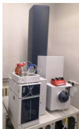
Монокристалльный дифрактометр D8 Quest, Bruker с детектором PHOTON II – микрофокусная молибденовая рентгеновская трубка luS Diamond
