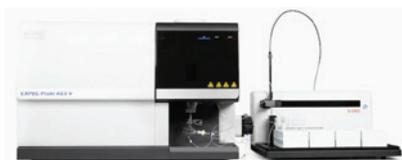
Атомно-эмиссионный спектрометр с индуктивно связанной плазмой (ICP) PlAgAES VExpec, КНР
